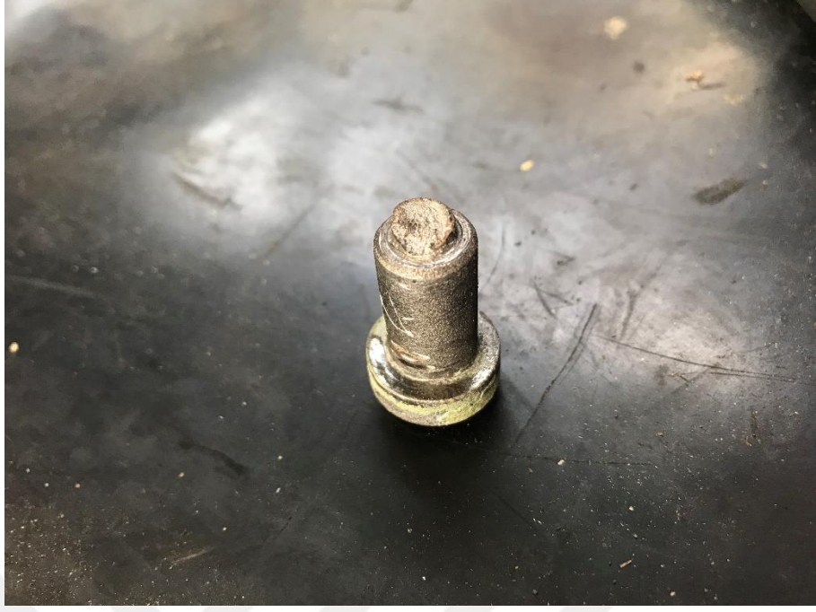
Şekil 1.2. Dinamik hasara uğramış bir bağlantı elemanı
