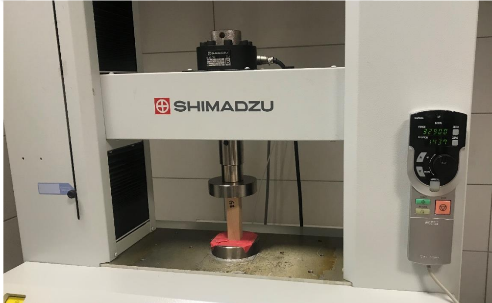
Şekil 3.6: Liflere paralel basma testi için kullanılan deney düzeneği ve SHIMADZU test cihazı.
