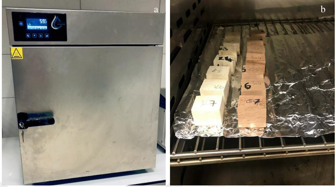
Şekil 3.2 : a. Etüv ve b. Yoğunluk tayini için hazırlanan örnekler.
