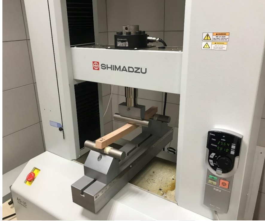
Şekil 3.4 : Üç nokta eğme deneyi için kullanılan test düzeneği ve SHIMADZU test cihazı.
