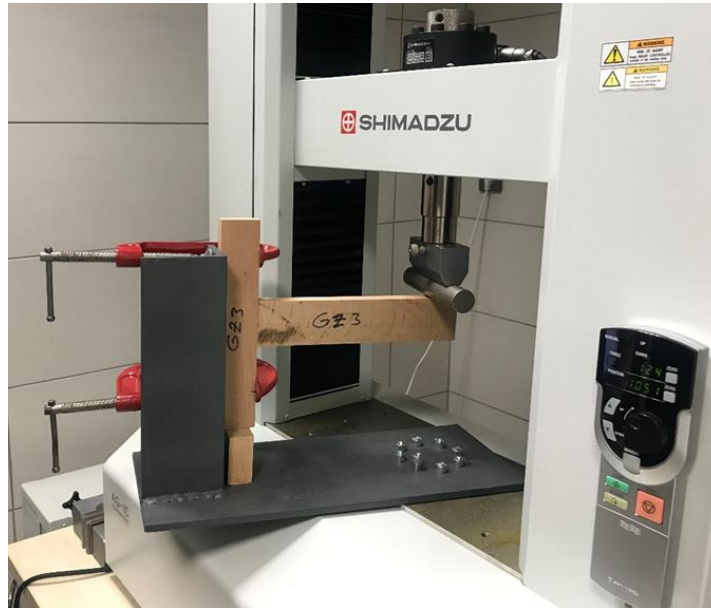
Şekil 3.16: SHIMADZU test cihazı ve T-tipi birleştirmeler için kullanılan statik yükleme test düzeneği.
